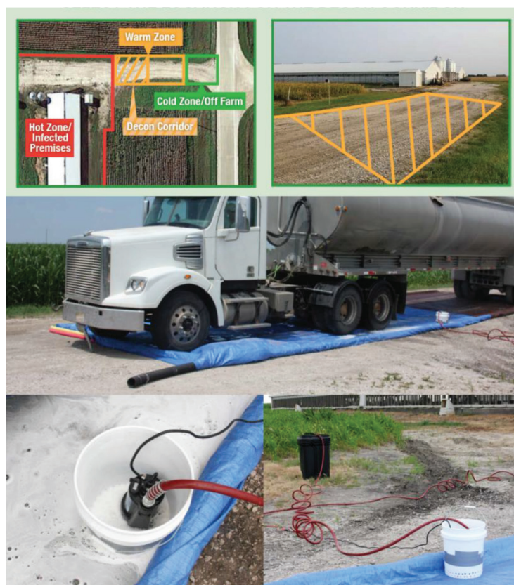
تصویر شماره ۳- نمونه ایستگاه شست و شوی سیار وسایل نقلیه (Temporary Cleaning and Disinfection Station: C&D) (۹).
